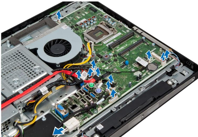
4. Entfernen Sie die Schrauben, mit denen die Systemplatine am Computer befestigt ist.
