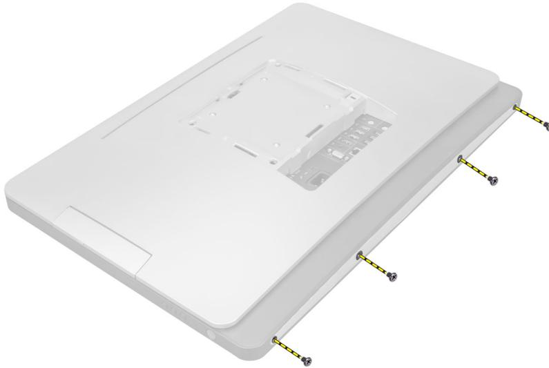
4. Heben Sie die Abdeckung an und entfernen Sie sie vom Computer mithilfe der Aussparungen in der Nähe der Eingabe/Ausgabe-Leiste.
