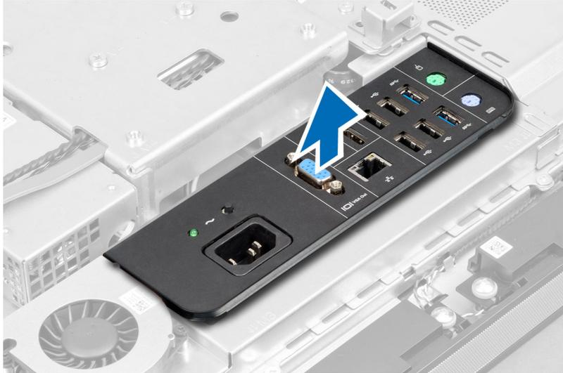
4. Entfernen Sie die Schrauben, mit denen der Netzanschluss an der Eingabe/Ausgabe-Platine befestigt ist.
