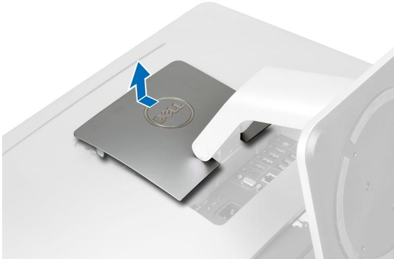
5. Entfernen Sie die Schrauben, mit denen der VESA-Standrahmen am Computer befestigt ist und heben Sie den VESA-Standrahmen vom Computer ab.
